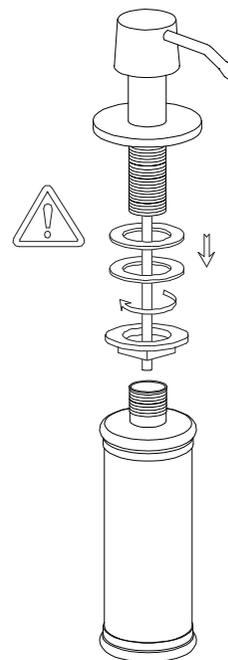
1. Retirez la bouteille au fond en la tournant dans le sens des aiguilles d'une montre. Retirez ensuite l'écrou et les rondelles de la même manière.
